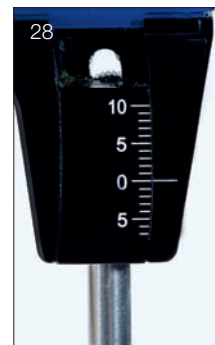
Fig. da 26 a 28 Imprecisioni interne al sistema comportano spesso un'occlusione irregolare dei modelli in gesso. Per questo motivo le strisce di carta oclusale non vengono trattene dappertutto allo stesso modo. Il perno di appoggio si trova però su zero.
