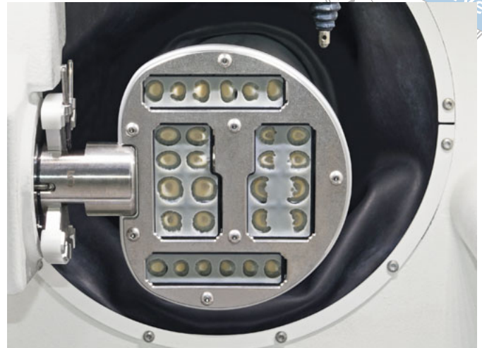
Abb. 1 Prothesenzahnrohlinge nach basaler Anpassung in der Ceramill Motion 2.
