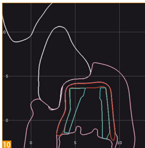
Abb. 10 Die Schnittdarstellung durch die Unterkieferprothese zeigt einen Stegfeiler über einer konischen Titanbasis mit passender Sekundärkonstruktion. Zu beachten ist hier die unter Einhaltung der notwendigen Materialstärken gleichmäßig erzeugte Freistellungen von Prothesenzahn und -basis, um den notwendigen Platz für die Stegkonstruktion zu schaffen.
