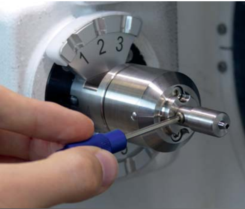
11 Der Preform-Rohling wird mit der Rohlingaufnahme der Maschine verschraubt und dadurch sowohl konzentrisch als auch axial ausgerichtet
