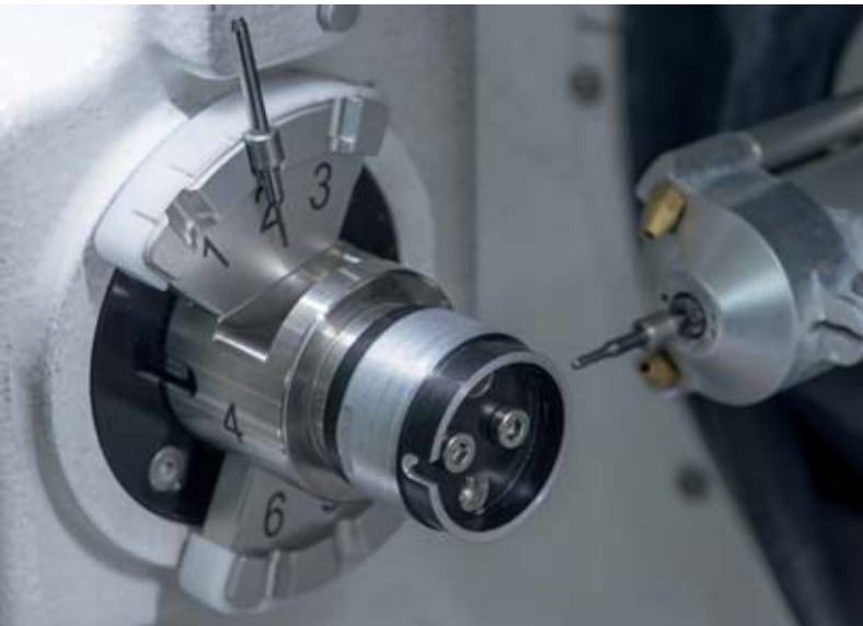
05 Ceramill Ti-Form-Werkzeughalter mit Kalibrierhülse in der Ceramill Motion 2. Dieser wird individuell in Form gefräst, um so den Werkstücknullpunkt in der Maschine zu definieren
