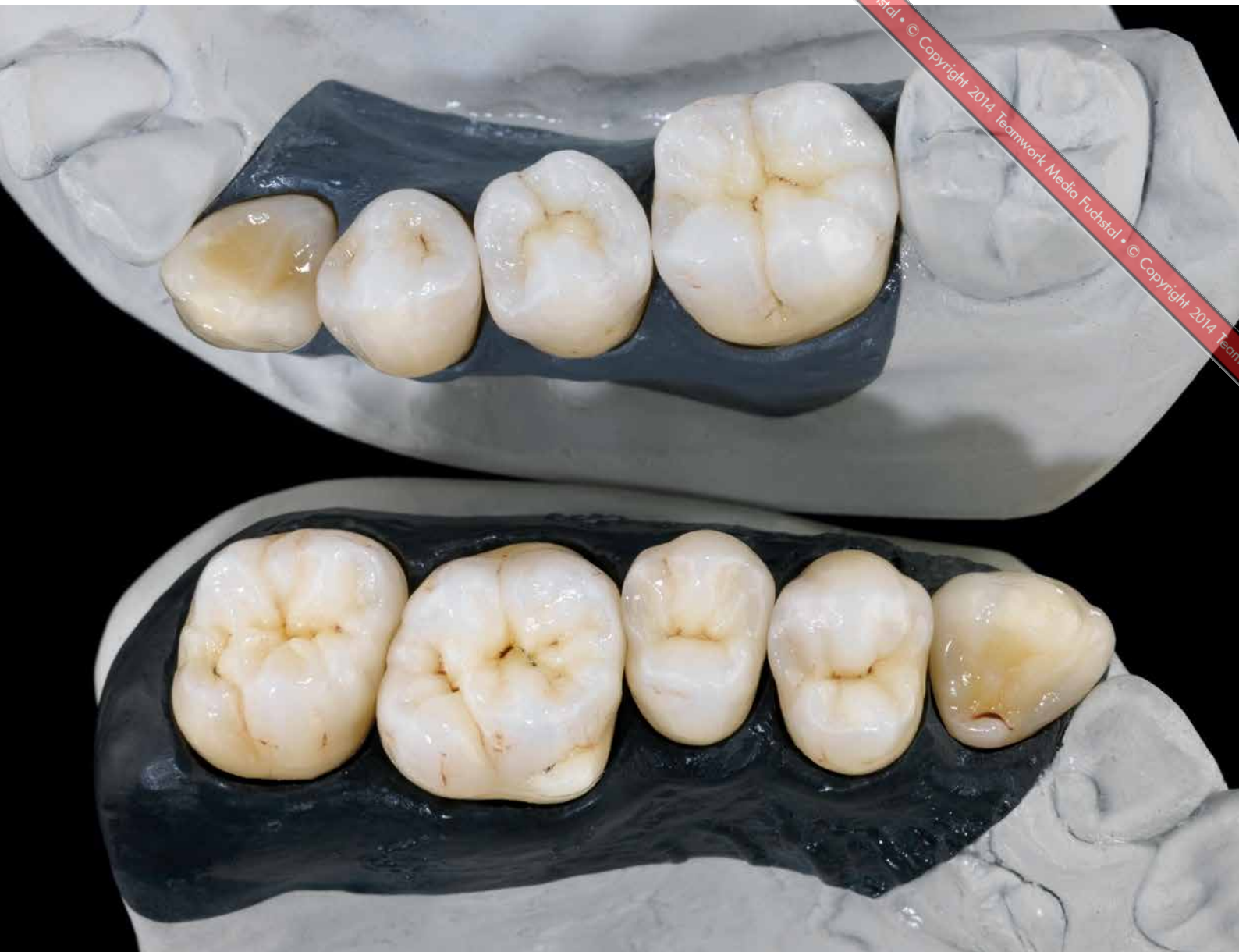
15 Gegenüberstellung von monolithischen Kronen aus dem sich derzeit in Entwicklung befindenden Super-Hochtransluzenten (SHT) Zolid-Zirkonoxid (auf den Zähnen 34 bis 36) und monolithischen Kronen aus Ceramill Zolid Classic (auf den Zähnen 14 bis 17). Die monolithischen Kronen aus SHT Zolid-Zirkonoxid auf den Zähnen 35 und 36 wurden im Dentinbereich mit Ceramill Liquid Grundfarbe und okklusal mit Ceramill Liquid Effektfarbe Orange eingefärbt. Finalisiert mit Ceramill Stains und Glaze
