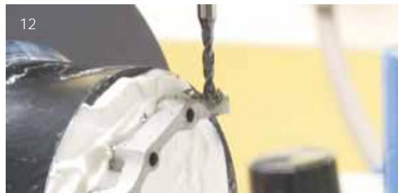
Abb. 12 Nun kann das Riegelauge gebohrt werden
