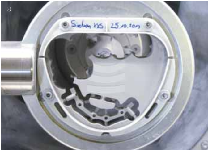
Abb. 8 Der fertig gefräste Ceramill Sintron-Steg kann aus der Motion 2 entnommen und ...
