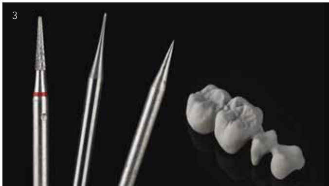
Abb. 3 und 4a Erster Schritt der individuellen Nachbearbeitung nach dem trockenen Fräsen in der Ceramill Motion/Motion2: Mit einem mittels Diamantscheibe zugespitzten (alten) Hartmetallfräser können die Fissuren und weitere Details im Grünlingszustand nachgearbeitet werden
