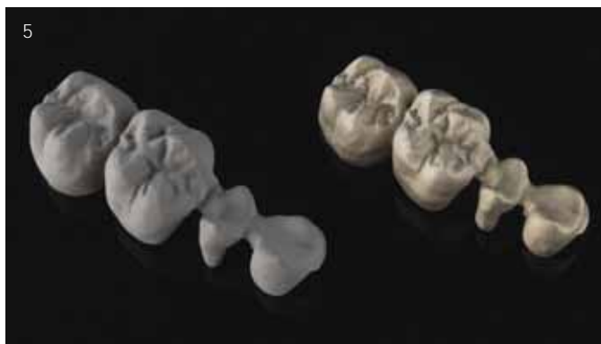
Abb. 5 Links im Bild die aus dem Ceramill Sintron Rohling herausgetrennte Brücke vor und rechts nach dem Sinterprozess. Das Material schrumpft dabei um 11 Prozent
