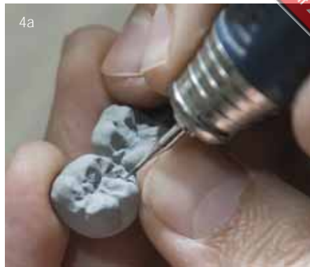
Abb. 3 und 4a Erster Schritt der individuellen Nachbearbeitung nach dem trockenen Fräsen in der Ceramill Motion/Motion2: Mit einem mittels Diamantscheibe zugespitzten (alten) Hartmetallfräser können die Fissuren und weitere Details im Grünlingszustand nachgearbeitet werden
