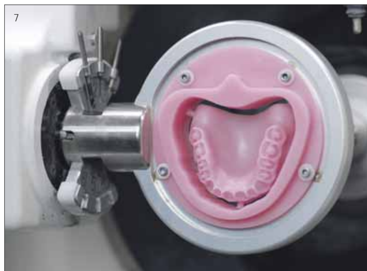
Abb. 7 Die aus Aufstellwachs unter Wasserkühlung gefräste Oberkieferbasis
