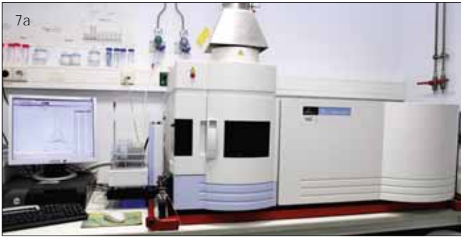
Abb. 7a und b ICP-Spektrometer zur Analyse der in Lösung gegangenen Metallionen und Ermittlung des Masseverlusts
