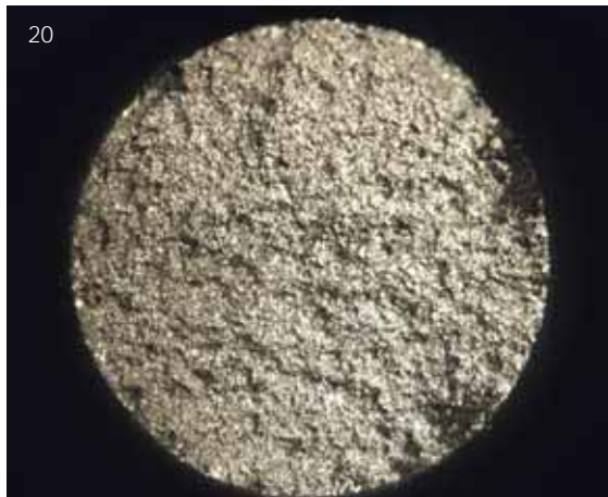
Abb. 20 Lichtmikroskopische Aufnahme einer exemplarischen Bruchfläche von Ceramill Sintron (25-fache Vergrößerung) mit homogener Struktur
