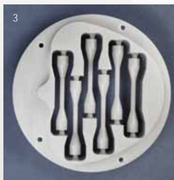
Abb. 3 Zugprobekörper im Wachsrohling. Diese werden nach dem Herausstrennen angestiftet, eingebettet und in Girobond NB gegossen
