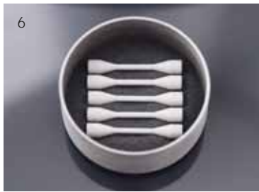
Abb. 6 Zum Sintern werden die Ceramill Sintron Zugproben auf einem Sinterbett gelagert
