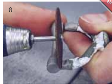
Abb. 8 Nach dem Abkühlen werden die Gussobjekte ausgebetet und die Gusskanäle von den Proben abgetrennt
