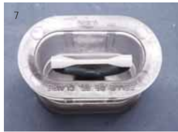
Abb. 7 Die gefrästeten Zugproben aus Wachs wurden angestiftet und in Muffeln für die Einbettung platziert
