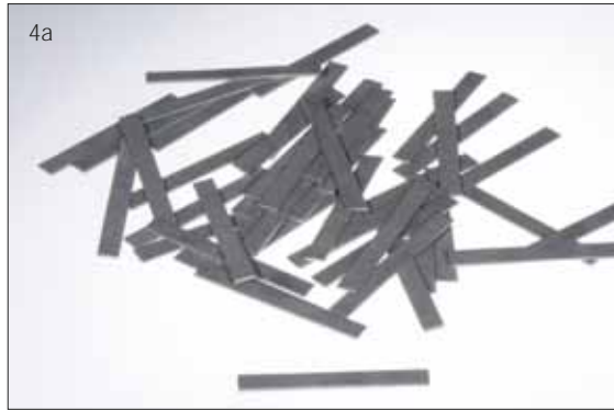
Abb. 4a Herstellung der Schwickerath- Prüfkörper nach EN ISO 9693:2000
