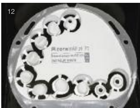
Abb. 12 Nach Abschluss der CAM kann der Datensatz wahlweise Inhouse oder Extern gefräst werden
