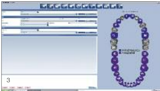
Abb. 3 In der Ceramill Mind Software wird die gewünschte Konstruktion festgelegt und Parameter wie beispielsweise die Wandstärke und das Fräsmaterial definiert
