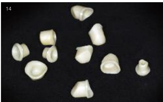
Abb. 14 Die Passung ist bereits im Weißlingszustand sehr gut. Daran ändert sich auch nach dem Dichtsinterprozess nichts
