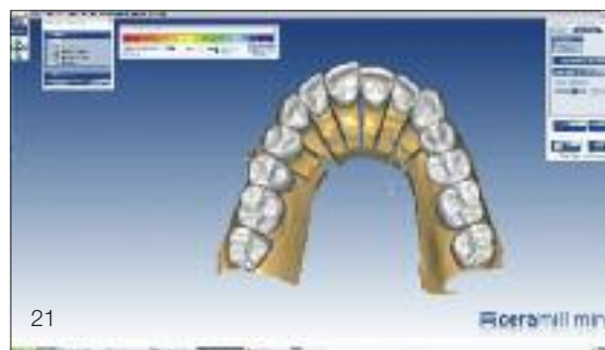
Abb. 20 und 21 Das Programm visualisiert die Kontaktsituation mittels unterschiedlicher Farben: Rot steht für eine zu starke Durchdringung der Antagonisten. Über die Software lässt sich die Kontaktbeziehung anpassen
