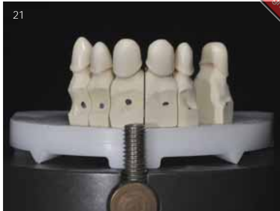
Abb. 20 Die gefrästen Teleskope im Zirkonoxid-Rohling. Der Rohlingsblank kann so lange wieder verwendet werden, bis er ideal ausgenutzt wurde
