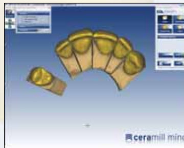
Abb. 5 Die Bibliothekszähne werden wie beim Set-up ideal positioniert
