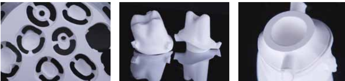
Abb. 12 bis 14 Die gefrästen und noch nicht dichtgesinterten Gerüste weisen bereits eine sehr hohe Präzision auf. Diese ist gusstechnisch nur sehr schwer so hinzubekommen
