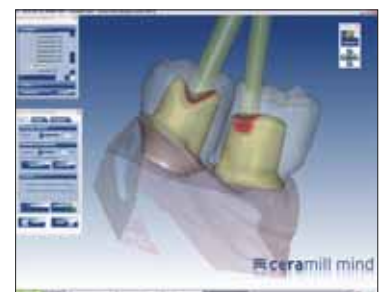
Abb. 4 bis 6 Um uns die Planung der Implantatversorgung zu vereinfachen, wurden im UK Set-up-Zähne aufgestellt und die Situation gescannt. Die Software Ceramill Mind erlaubt die exakte Übertragung der Implantatposition, ceramill mind die einfache Konstruktion der Aufbauteile
