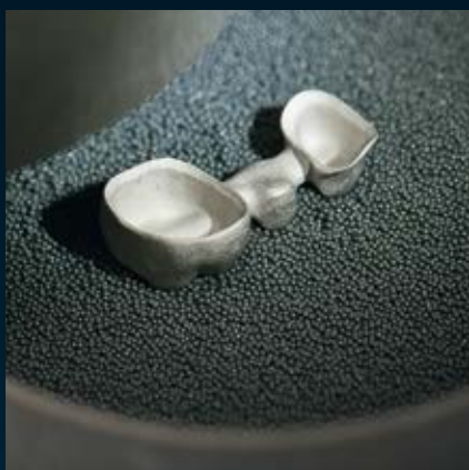
7 Ceramill Sintron® 修复体烧结完成后从Ceramill Argotherm烧结炉中取出
