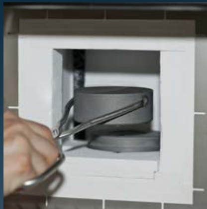
5 盖上相应的烧结盖, 放置在烧结炉中
