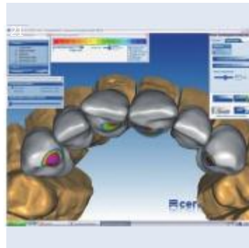
21 model로 된 치아의 contact 부위가 다시 보입니다.
