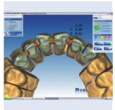
26 Crown을 splinting 하기 위한 connector는 사용하는 소재가 요구하는 최소 직경을 계산하여, 자동으로 설계를 합니다.
