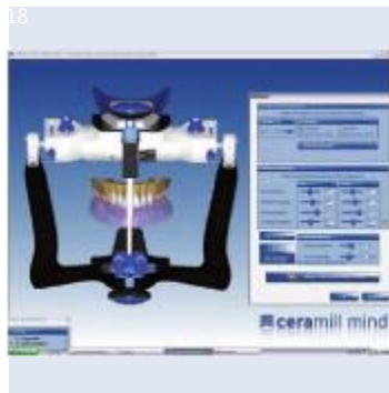
시상과로각의 condylar guidance, Bennett angle, immediate sides hift 및 custom incisal guidance table 같은 운동을 실제 교합기에서 하는 것처럼 프로그램에서 수행됩니다.
