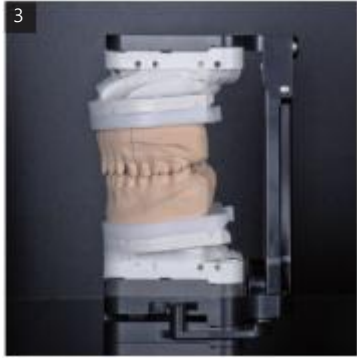
3 교합기 상태의 모델은 Ceramill Fixator를 이용하여 완벽하게 이동할 수 있습니다. Ceramill Fixator는 Ceramill Map300 Scanner 안에서 Splitex® base 위에 위치합니다.
