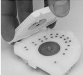
Sekundärplatte auf fertiges Giroformmodell aufsetzen.
