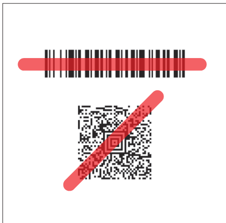
Fig. 2 : Processus de lecture du faisceau de visée
